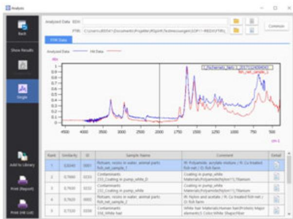
После выбора спектра FTIR вы получите список возможных положений из выбранной вами базы данных, например, по анализу загрязнений, который вы делали ранее. Результаты могут быть различаться, т.к. EDXIR использует иную структуру базы данных, чем LabSolutions IR. Вы можете сравнить их наложение в верхней половине окна.
