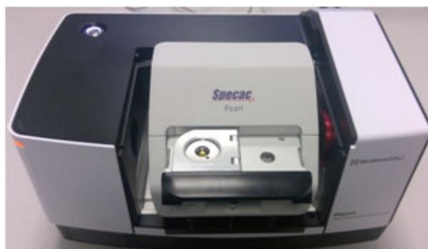
Проведите анализ от самой низкой до самой высокой концентрации и протирайте ZnSe окно мягкой тканью после каждого измерения. Если спектр имеет плохое качество (нет чётких полос этанола в режиме поглощения), проверьте образец на наличие пузырьков воздуха.
