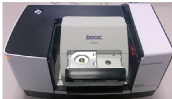
Проведите анализ от самой низкой концентрации оливкового масла до самой высокой концентрации, не забывая чистить ZnSe пластину мягкой тканью после каждого измерения.
