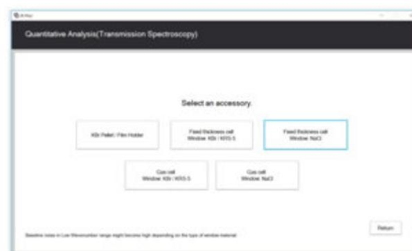
IR Pilot далее автоматически загрузит правильные параметры, запустит сканирование фона и попросит установить образец.
