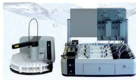
2-х каналный автоматизированный анализатор для определения цианидов/фенолов в воде
