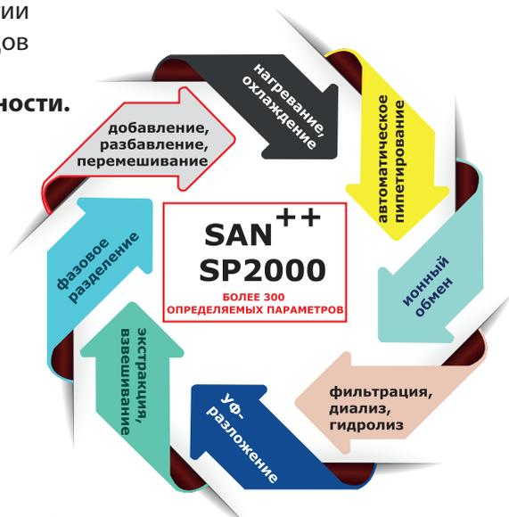
Благодаря модульной конструкции San++ имеет возможность конфигурирования системы под конкретные задачи пользователя.
