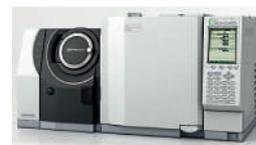
Определение содержания остаточного количества 400 индивидуальных пестицидов в одном образце, как правило, требует проведения двух или трех последовательных анализов. При использовании газового хромато-масс-спектрометра с тройным квадруполом **GCMS-TQ8040** достаточно всего одного анализа. Это существенно увеличивает производительность работы аналитической лаборатории.
