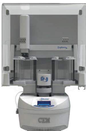
Система предназначена для последовательной подготовки проб к элементному анализу методами ААС, АЭС-ИСП и ИСП-МС
