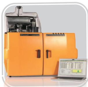
**DUMATHERM®** - ключевой компонент пищевых лабораторий для **определения азота по методу Дюма**.
