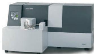
Точное измерение распределения частиц по размерам является сегодня важным инструментом в лабораториях экологических и природоохранных предприятий. Лазерный анализатор размеров частиц **SALD-2300** представляет новый стандарт инструментов для анализа размеров частиц в линейке анализаторов SALD. Широкий ряд опций позволяет использовать прибор в самых разных отраслях.
